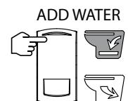
Während des Eindrückens des Schalters (ADD WATER) wird das Magnetventil geöffnet, um Wasser in die Toilettenschüssel strömen zu lassen.
