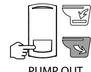
Während des Eindrückens des Schalters (PUMP OUT) läuft der Motor, der die Klingen und die Pumpe antreibt. Die Fäkalien und das Toilettenpapier werden nun zermahlen und abgepumpt.
