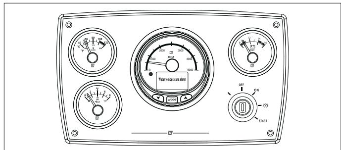
Le tableau est équipé d'une alarme sonore intégrée et peut être utilisé comme tableau simple, premier ou secondaire.
