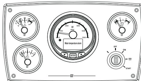
El panel tiene una alarma acústica incorporada y se puede utilizar como panel independiente o como primer o segundo panel.
