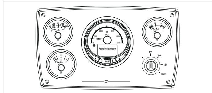
Das Bedienfeld hat einen eingebauten akustischen Alarm und kann als Einzel-, Erstes- oder Zweites Bedienfeld verwendet werden.
