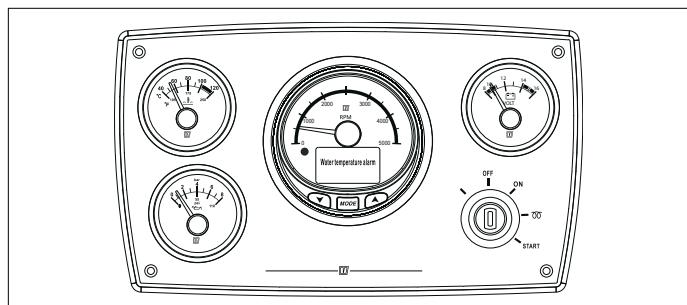
Il pannello è dotato di un allarme acustico incorporato e può essere utilizzato come pannello singolo, primo o secondo.
