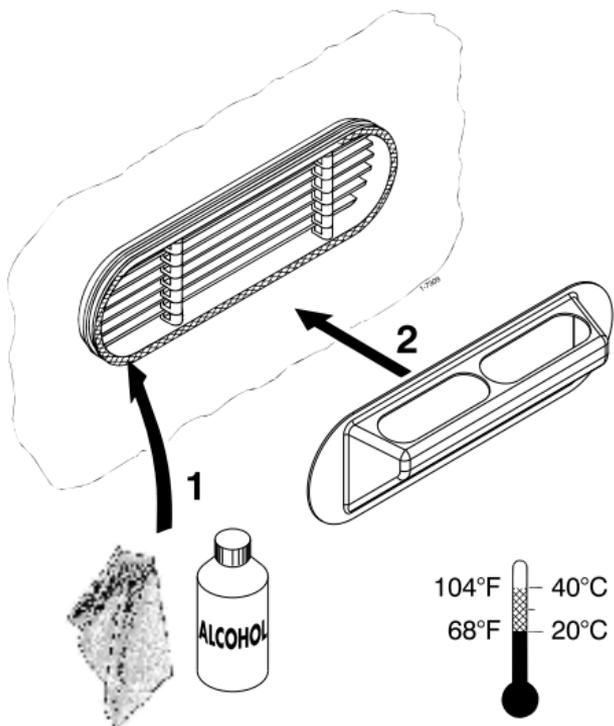
Voor een goede hechting van de tape dient het oppervlak van het frame, aluminium of roestvaststaal, **schoon** en **droog** te zijn. Reinig het oppervlak met een in alcohol (70%) gedrenkte doek. **BELANGRIJK:** Alcohol is ontvlambaar. - Niet gebruiken nabij warmtebronnen, vonken en open vuur. - Niet roken.
