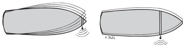
Om een optimaal resultaat te bereiken dient de tunnelbuis zover mogelijk vooraan in het schip te worden geplaatst. ◀
