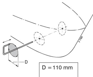
Breng de gaten aan, afhankelijk van het materiaal van de scheepsromp met een decoupeerzaag of een snijbrander. ◀
