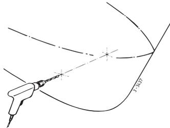
Das selber anzufertigende Anreiß-Werkzeug durch die beiden vorgebohrten Löcher führen und den Außendurchmesser des Tunnelrohrs auf den Rumpf anreißen. ◀
