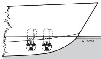
Desaconsejamos la instalación de 2 hélices de proa en un solo conducto de propulsión (1); ino se logra ninguna duplicación de la fuerza de propulsión! ◀
