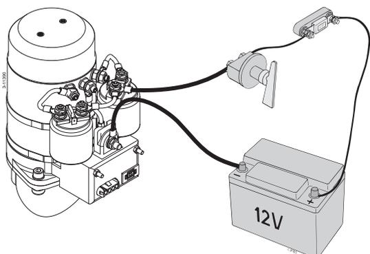
Raccordement des câbles du courant principal. ◀
