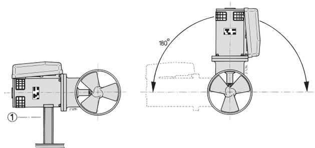
El electromotor se puede incorporar en diferentes posiciones. Si se instala horizontalmente, es absolutamente necesario darle un soporte. El electromotor en todo momento deberá instalarse por encima del nivel máximo del agua de sentina ( ◀ ① ). ◀
