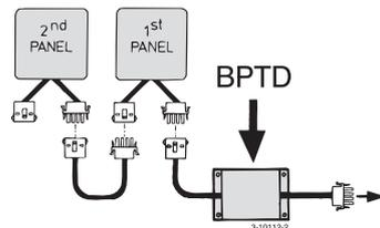
Si hay dos puestos de mando el segundo tablero se puede conectar al primer tablero.
