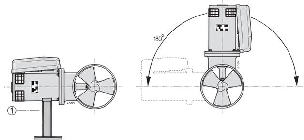
Der Elektromotor kann in verschiedenen Aufstellungen eingebaut werden.
