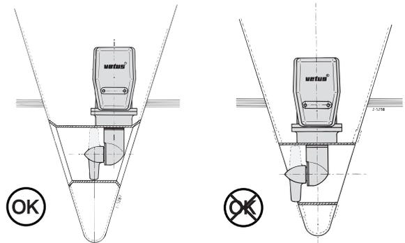
En choisissant l'endroit où l'hélice d'étrave sera posée, il faut tenir compte que l'hélice ne débordera pas l'ouverture du tunnel.
