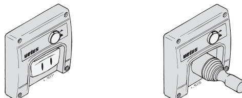
Monteer het bedieningspaneel bij de stuurstand. De vrije ruimte achter het paneel moet minimaal 50 mm bedragen. ◀
