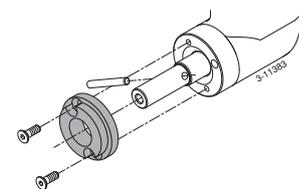
Limpiar el eje de la hélice, engrasarlo con 'outboard gear grease' y volver a montar la hélice en el eje. ◀
