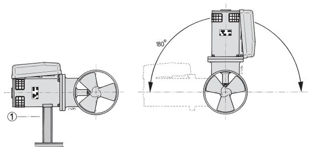
Le moteur électrique peut être installé en diverses positions. Si le moteur est placé à l'horizontale, un support est absolument nécessaire. Assurez-vous que la position du moteur électrique est toujours bien au-dessus du niveau de l'eau de cale (☛ ①). ◀
