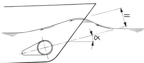
Elija el largo 'L' para un enmaestrado de entre 1 x D y 3 x D. Un enmaestrado se incorporará de tal modo en el casco que el eje central del enmaestrado coincida con la forma prevista de la ola de proa. ◀
