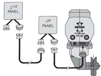
Anmerkung: Die Farben der Leiter in den Zwischenkabeln können von den Kabelfarben, die beim Bugschraubenmotor oder dem Armaturenbrett Anwendung finden, abweichen! ◀
