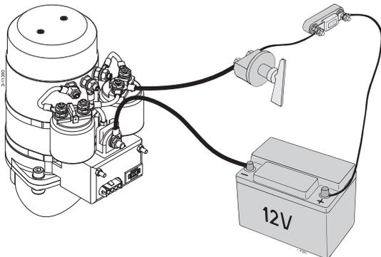
Die Hauptstromkabel anschließen. ◀
