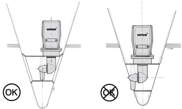
Al momento di determinare l'esatta posizione dell'elica nel tunnel è necessario tenere presente che l'elica NON deve fuoriuscire dal tunnel.
