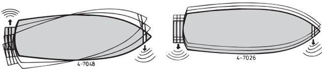
Au cas où il faut contrôler également les mouvements latéraux de l'arrière du bateau (à part des mouvements de l'étrave) une hélice 'd'étrave' pourra être utilisée comme hélice de poupe. ◀
