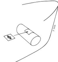
Important: Les trous doivent être percés exactement à l'axe central de la tuyère.
