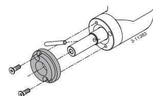
Nettoyez l'arbre porte-hélice, graissez-le avec le produit 'outboard gear grease' et montez à nouveau l'hélice sur l'arbre. ◀
