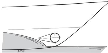
Installation de 2 hélices d'étrave l'une derrière l'autre (pour grands bateaux). Dans ce type de montage, on utilise une ou deux hélices selon l'état du temps.
