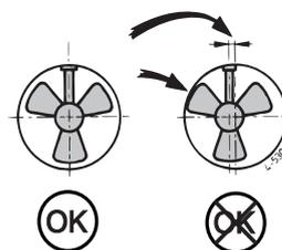
Das Gewinde der Bolzen mit 'outboard gear grease' einfetten und den Elektromotor zum Zwischenflansch montieren. Als erste Probe den Propeller von Hand drehen; das sollte reibungslos geschehen, als zugleich die Welle des Elektromotors mitgenommen wird. ◀
