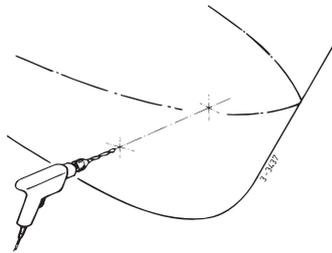
Passer l'outil à marquer (à construire par vous-même) à travers les 2 trous percés et marquer le diamètre extérieur de la tuyère sur la coque.
