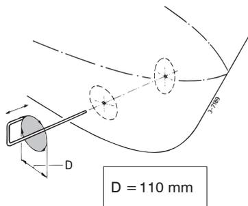
Abhängig vom Baumaterial des Schiffes, die Löcher ausschneiden mit Hilfe einer Stichsäge oder eines Schneidbrenners. ◀
