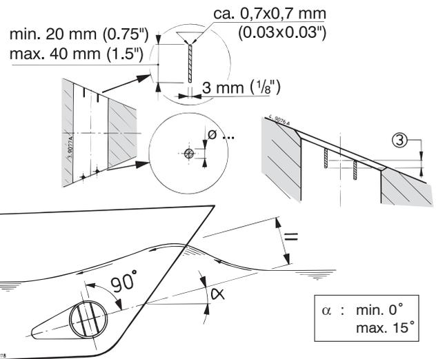
Hoewel de stuwkracht hierdoor ongunstig wordt beïnvloed kunnen, ter bescherming van de schroef, in de openingen van de tunnelbuis spijlen worden aangebracht.
