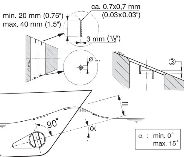
Afin de protéger l'hélice, il sera possible d'installer des barres dans les ouvertures de la tuyère, bien que ceci exercera une mauvaise influence sur la poussée de l'hélice d'étrave.
