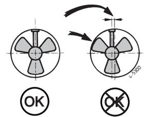
Vet de schroefdraad van de bouten in met 'outboard gear grease' en monteer de electromotor op de tussenflens. Draai ter controle met de hand de schroef rond, deze moet gemakkelijk zijn rond te draaien, waarbij de electromotoras wordt meegenomen. ◀
