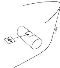
Importante: El patrón de orificios debe de quedar exactamente sobre el eje central del conducto de propulsión. ◀
