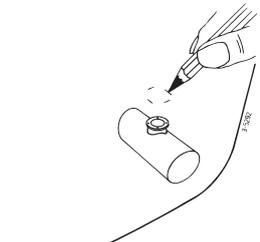
Die mitgelieferte Schablone für die richtige Platzbestimmung der zu bohrenden Löcher verwenden. ◀
