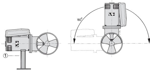
De boegschroef kan in verschillende standen worden ingebouwd, van horizontaal tot verticaal naar boven. Als de motor horizontaal wordt opgesteld is ondersteuning absoluut noodzakelijk. De electromotor dient steeds boven het maximale niveau van het bilge-water ( ◀ ① ) te worden opgesteld. ◀
