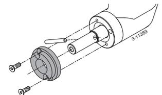
Reinig de schroefas, vet deze in met 'outboard gear grease' en monteer de schroef terug op de as. ◀
