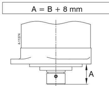
Die Schraubenwelle mit 'outboard gear grease' einfetten und die Schraube montieren. ◀
