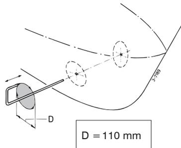
Dépendant au matériau de construction du bateau, couper les trous à l'aide d'une scie ou d'un brûleur à découper.
