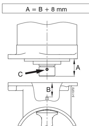
Ensuite, monter de permanence la bride intermédiaire à l'embase. Graisser d'abord le filetage des boulons avec de l'"outboard gear grease". ◀
