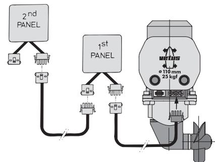
Nota. ¡Los colores de los hilos en el cable intermedio pueden ser distintos de los colores de hilo aplicados en el motor de la hélice de proa así como en el tablero de mandos! ◀
