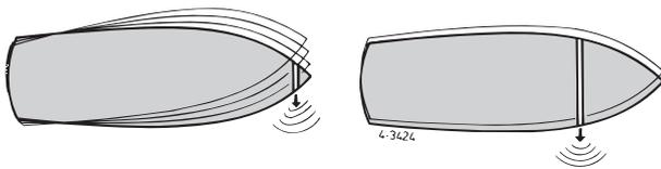
Afin d'obtenir le meilleur résultat, la tuyère doit être installée le plus à l'avant possible. ◀
