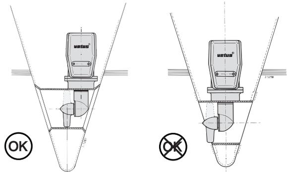
Al determinar el lugar donde colocar la hélice de proa en el conducto, se debe tomar en cuenta que la hélice NO puede salir del conducto.
