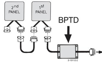
Indien twee stuurstanden aanwezig zijn kan het tweede paneel op het eerste paneel worden aangesloten.
