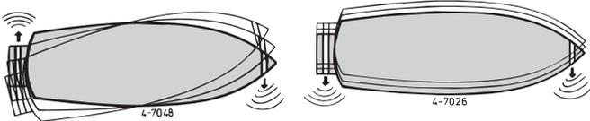
Si al lado de los movimientos de la proa del barco, es preciso controlar también los movimientos del espejo en sentido lateral, se puede instalar además una hélice de 'proa' a la altura del lado posterior del barco. ◀
