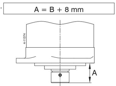
Vet de schroefas in met 'outboard gear grease' en monteer de schroef. ◀
