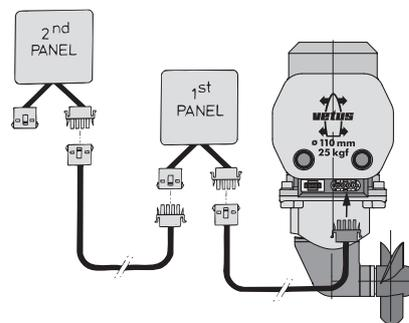
N.B. Les couleurs des fils du câble intermédiaire peuvent différer légèrement de celles utilisées sur le moteur d'hélice d'entrave et sur le panneau de commande ! ◀
