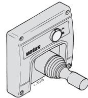
Das Armaturenbrett am Steuerstand einbauen. Hinter dem Armaturenbrett muß ein Freiraum von mindestens 50 mm vorhanden sein. ◀
