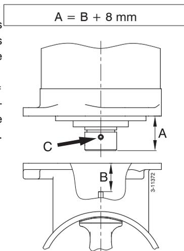
Monteer nu de tussenflens definitief op het staartstuk, vet de schroefdraad van de bouten in met 'outboard gear grease' alvorens deze te monteren. ◀
