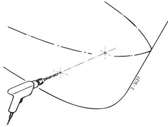
Pasar la herramienta de marcación (a ser elaborada por uno mismo) por ambos orificios preperforados y marcar la circunferencia del diámetro exterior del conducto en el casco. ◀
