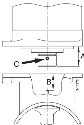
Controlar ahora la medida 'A' ('A' = 'B' + 8 mm). Utilizar en su caso el tornillo de ajuste 'C' para obtener la medida 'A' correcta. ◀
