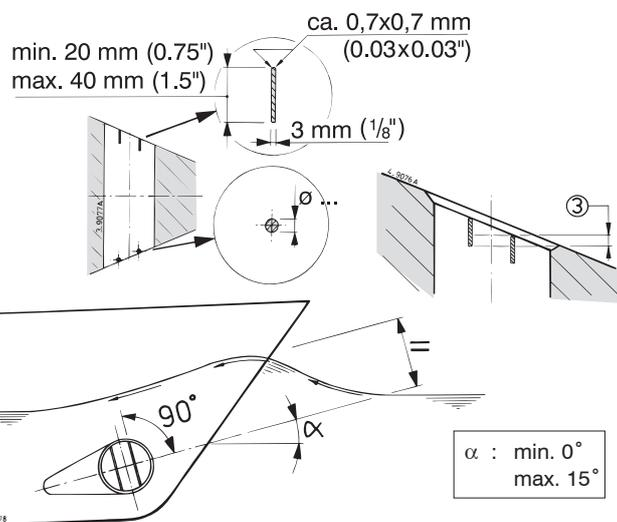
Aunque ello influye negativamente la fuerza de propulsión, se pueden colocar barras en los orificios del conducto para proteger la hélice.
