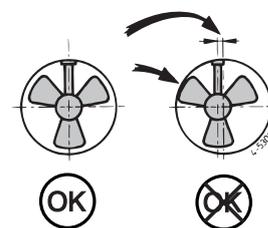
Lubrificare la filettatura dei bulloni con dell'olio per motori fuoribordo e montare il motore elettrico sulla flangia intermedia. Per controllare, far ruotare l'elica con la mano, deve poter girare senza attrito, pur essendo collegata all'albero del motore. ◀
