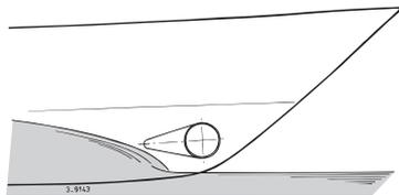
Instalación de 2 hélices de proa una detrás de otra para buques más grandes. En este caso, dependiendo de las condiciones climatológicas, se pueden utilizar una o ambas hélices de proa.
