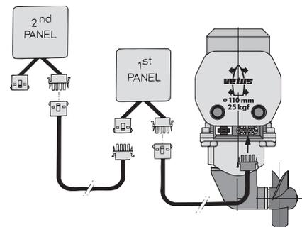
N.B. I colori dei cavi della prolunga possono essere diversi dai colori dei cavi utilizzati sul motore dell'elica e sul pannello di comando! ◀
