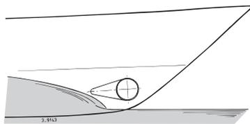
Installazione di due eliche di prua l'una dietro l'altra per le imbarcazioni di grosse dimensioni. In questo caso, a seconda delle condizioni meteorologiche, le eliche possono essere usate singolarmente o simultaneamente.
