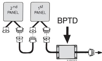
Wenn zwei Steuerstände vorhanden sind, kann das zweite Armaturenbrett am ersten angeschlossen werden.
