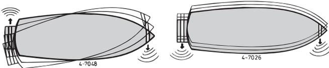
Se, oltre ai movimenti della prua della nave, è necessario controllare anche i movimenti laterali della poppa, è possibile installare anche un'elica di prua all'altezza della parte posteriore della nave. ◀
