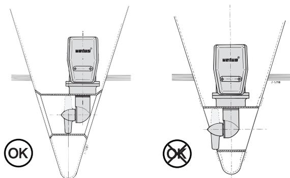
Bij het kiezen van de plaats waar de boegschroef in de tunnelbuis wordt geplaatst dient er rekening mee te worden gehouden dat de schroef NIET buiten de tunnelbuis mag uitsteken. De schroef dient zich bij voorkeur op de hartlijn van het schip te bevinden, maar moet van buiten wel altijd bereikbaar zijn. ◀
