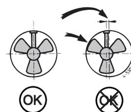
Graisser les filetages des boulons avec de l'"outboard gear grease" et poser le moteur électrique sur la bride intermédiaire. Contrôler, en tournant l'hélice à main, ce doit se faire sans friction, quand l'arbre du moteur électrique est prise. ◀
