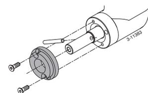
Die Schraubenwelle reinigen, mit 'Outboard gear grease' einfetten und die Schraube wieder an der Achse einbauen. ◀
