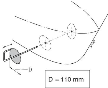
Realizar los orificios, según el material del casco, con ayuda de una sierra de calar o un cortador soplestista. ◀
