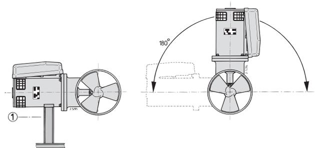
Il motore può essere montato in diverse posizioni. Se il motore è collocato in posizione orizzontale, è assolutamente necessario un supporto. Il motore deve essere sempre collocato al di sopra del livello massimo dell'acqua di sentina ( ◀ ① ). ◀
