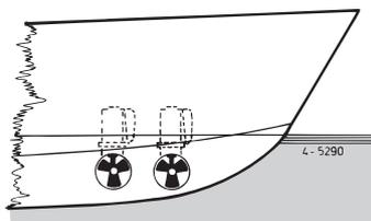
Wir raten davon ab, 2 Bugschrauben in einem (1) Tunnelrohr einzubauen. Eine Verdoppelung der Antriebskraft wird dadurch nicht erreicht! ◀
