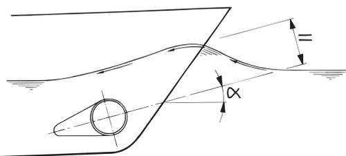
La longueur 'L' de la coquille sera entre  $1 \times D$  et  $3 \times D$ . Cette coquille sera incorporée dans la coque du bateau de telle sorte, que la ligne centrale se confondra avec la forme de la vague de l'étrave prévue. ◀
