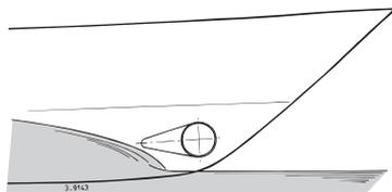
Einbau von 2 Bugschrauben hintereinander für größere Schiffe. Hierbei kann man, abhängig vom Wetter, eine oder beide Bugschrauben benutzen. ◀
