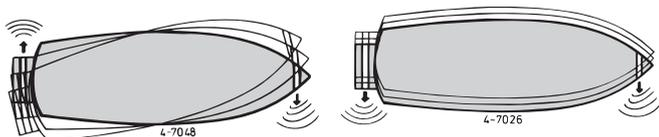
Indien behalve de bewegingen van de boeg van het schip ook de bewegingen van de spiegel in zijwaartse richting beheerst moeten kunnen worden kan ook een 'boeg'schroef ter hoogte van de achterzijde van het schip worden geïnstalleerd. ◀
