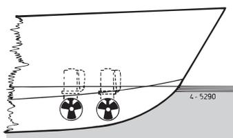
Wij raden de installatie van 2 boegschroeven in één (1) tunnelbuis af; er wordt geen verdubbeling van de stuwkracht bereikt! ◀
