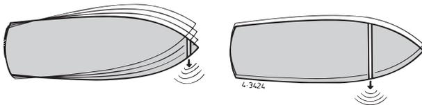
Per ottenere un risultato ottimale, collocare il tunnel dell'elica il più possibile verso la prua dell'imbarcazione. ◀
