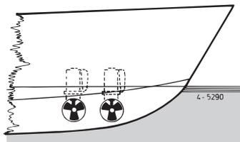
Nous déconseillons l'installation de 2 hélices d'étrave dans un seul tunnel tubulaire ; on n'obtiendra pas une force de propulsion double ! ◀
