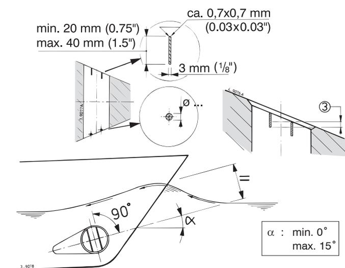
Per proteggere l'elica si possono mettere delle sbarre nelle aperture del tunnel, anche se questo influenza negativamente la propulsione.
