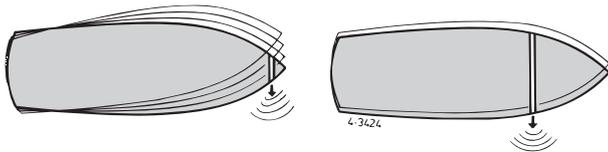
Für optimale Ergebnisse soll das Tunnelrohr möglichst weit nach vorne in den Bug montiert werden. ◀
