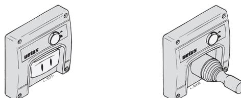
Monter le panneau de contrôle sur le poste de conduite. L'espace libre derrière le panneau doit être d'au moins 50 mm. ◀
