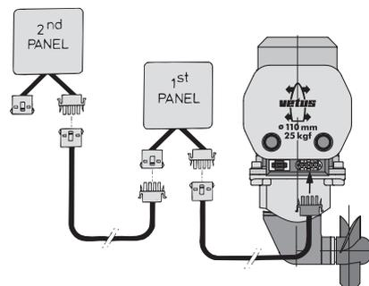
N.B. De kleuren van de aders in de tussenkabel kunnen afwijken van de draadkleuren zoals toegepast op de boegschroefmotor en op het bedieningspaneel! ◀
