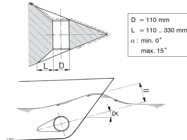
Kies de lengte 'L' voor een schelp tussen 1 x D en 3 x D. Een schelp dient zodanig in de scheepsrump te zijn opgenomen dat de hartlijn van de schelp samenvalt met de te verwachten vorm van de boeggolf. ◀
