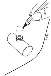
Afin de déterminer la position correcte des trous à percer, utiliser le gabarit fourni.
