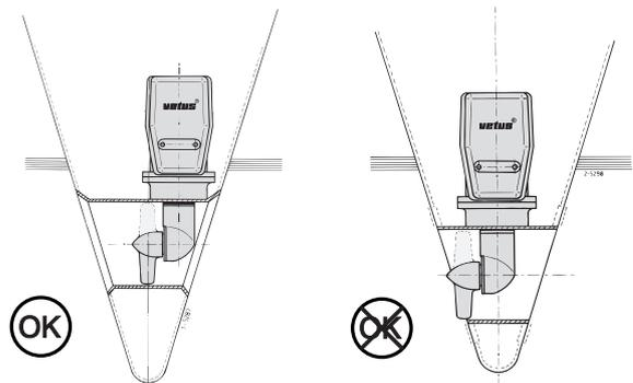
Bei der Platzwahl wo die Bugschraube in das Tunnelrohr eingebaut werden soll, ist zu bedenken daß die Bugschraube NIE aus dem Tunnelende herausragen darf.
