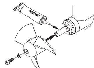
A présent l'hélice doit tourner librement à 1,5 mm minimum de la paroi de la tuyère. ◀
