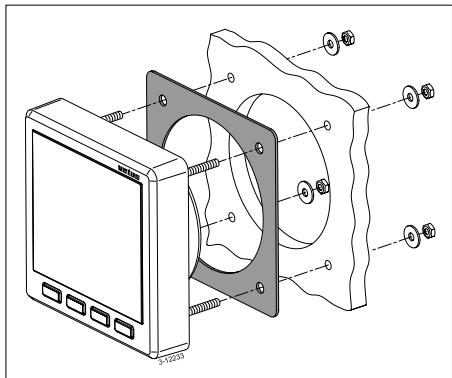
Con ayuda de la plantilla provista haga los orificios en el panel de instrumentos o en un mamparo. Use los 4 tornillos sin cabeza y tuercas provistos para montar el instrumento de lectura. Compruebe que el empaque se encuentre bien puesto entre el instrumento de lectura y el panel o el mamparo.
