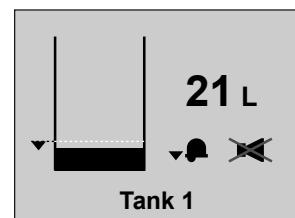
Alarma baja, con silenciador de alarma acústica.
