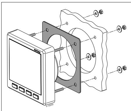
Bohren Sie mit Hilfe der mitgelieferten Schablone die Löcher in die Instrumententafel oder in ein Schott. Montieren Sie das Ableseinstrument mit den 4 mitgelieferten Gewindestrauben und Muttern. Vergewissern Sie sich, dass die Dichtung richtig zwischen dem Ableseinstrument und der Instrumententafel bzw. dem Schott angebracht ist.
