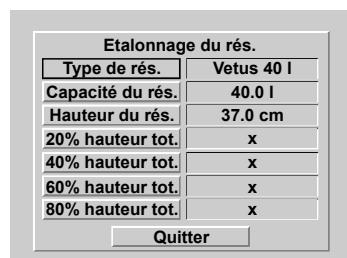
A la livraison du capteur, le type de réservoir est réglé sur Vetus 40 l.
