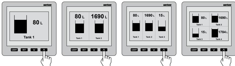
Durchlaufen der Tanks auf dem Bildschirm, wenn mehr Tanks vorhanden sind als gleichzeitig auf dem Bildschirm angezeigt werden können:
