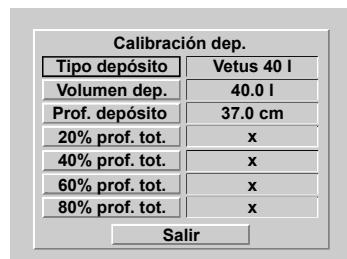
El sensor está calibrado en la fábrica para el tipo de depósito Vetus 40 l.
