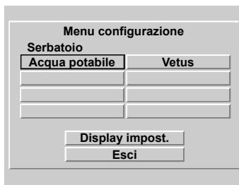
Selezzionate il sensore appena collegato con i tasti **▼** / **▲** e premete 2 volte il tasto **SET**; lo strumento di lettura visualizzerà nuovamente la tastiera ed il nome del serbatoio.
