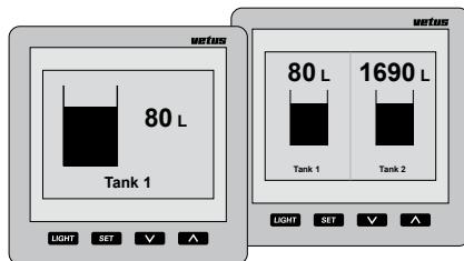
Los ajustes para los depósitos se pueden regular en cualquiera de los dos instrumentos de lectura y quedan registrados en los dos instrumentos automáticamente.
