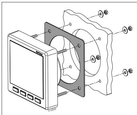
Con l'aiuto della sagoma in dotazione, praticate i fori nel pannello degli strumenti o in un tramezzo. Montate lo strumento di lettura con le 4 filettature ed i dadi in dotazione. Assicuratevi di avere correttamente applicato la guarnizione tra lo strumento di lettura ed il pannello degli strumenti o il tramezzo.
