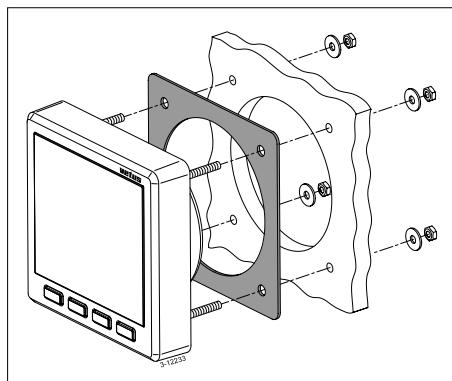
Maak, met behulp van de meegeleverde mal, de gaten in het instrumentenpaneel of in een schot. Montere het afleesinstrument met de 4 meegeleverde draadeinden en moeren. Overtuig U ervan dat de pakking zich op de juiste wijze tussen het afleesinstrument en het paneel of het schot bevindt.
