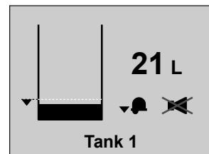
Laag alarm, met een onderdrukt akoestisch alarm.
