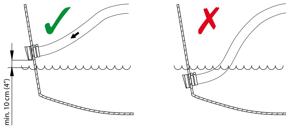
**Rubber uitlaatslang****Rubber exhaust hose****Gummi Auspuffschlauch****Tuyau d'échappement neoprène****Manguera de escape de goma****Tubo di scappamento in gomma**
