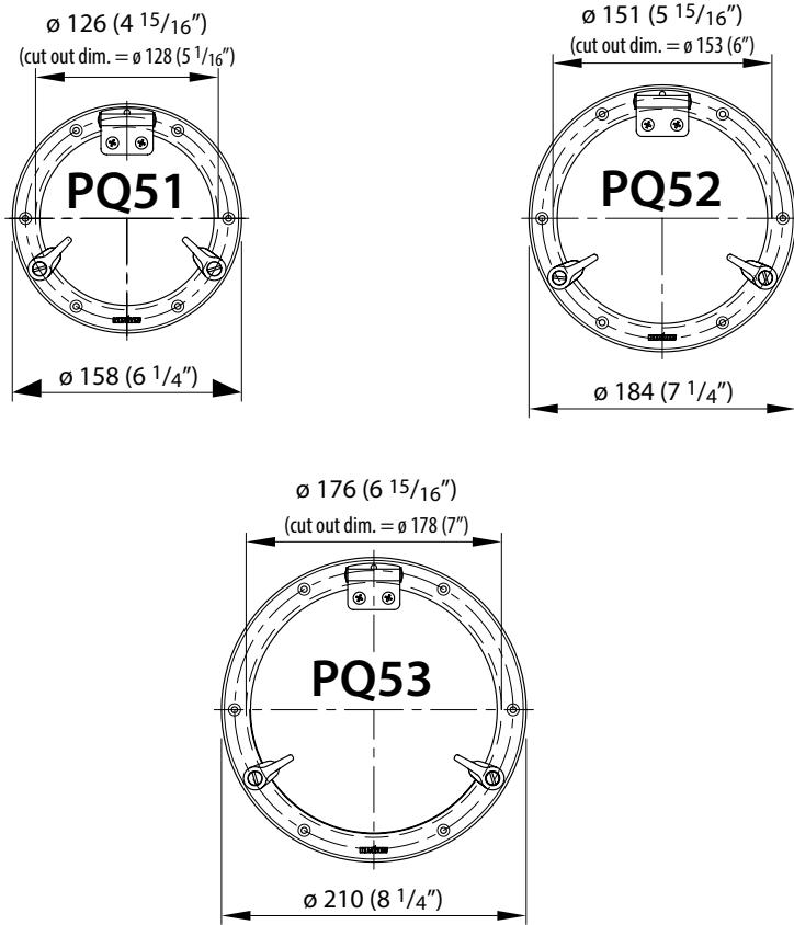
De bij de streeplijnen aangegeven afmetingen zijn de inbouwmaten.
