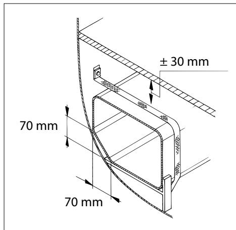
Veiller à disposer d'une base suffisamment stable pour pouvoir installer et fixer solidement le réservoir.
