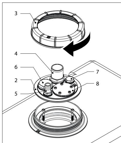
**Attention : seul le capteur de niveau à ultrasons (SENSORA) peut être utilisé !**
