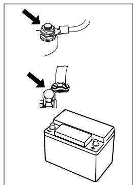
Seguire le istruzioni del costruttore per quanto riguarda la manutenzione delle batterie. Le batterie VETUS non richiedono manutenzione.
