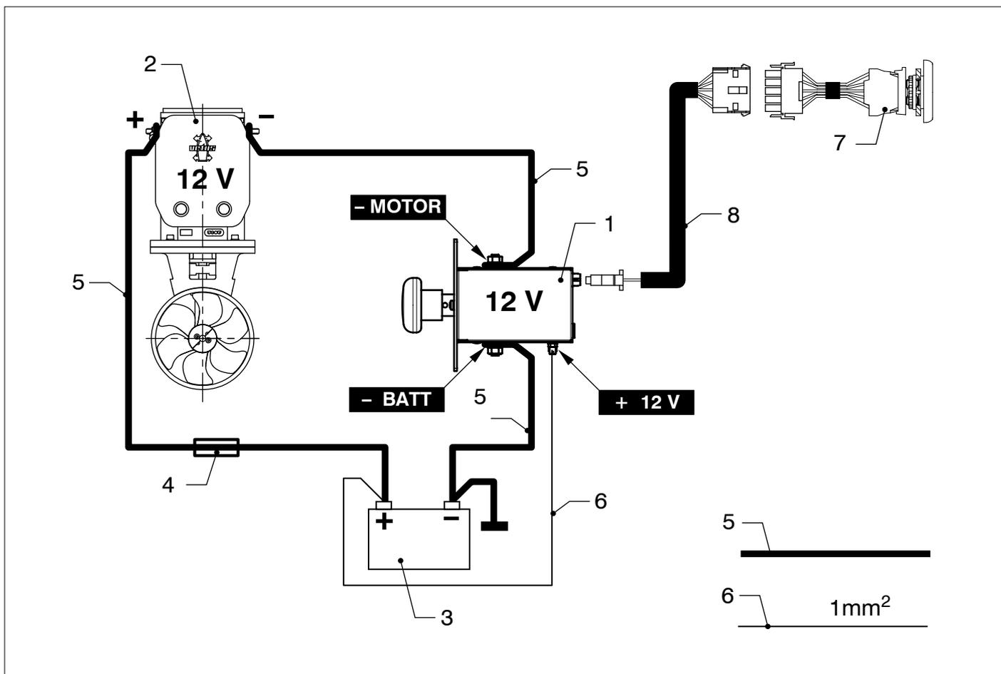
Installatievoorbeeld met een 12 Volt boegschroef
