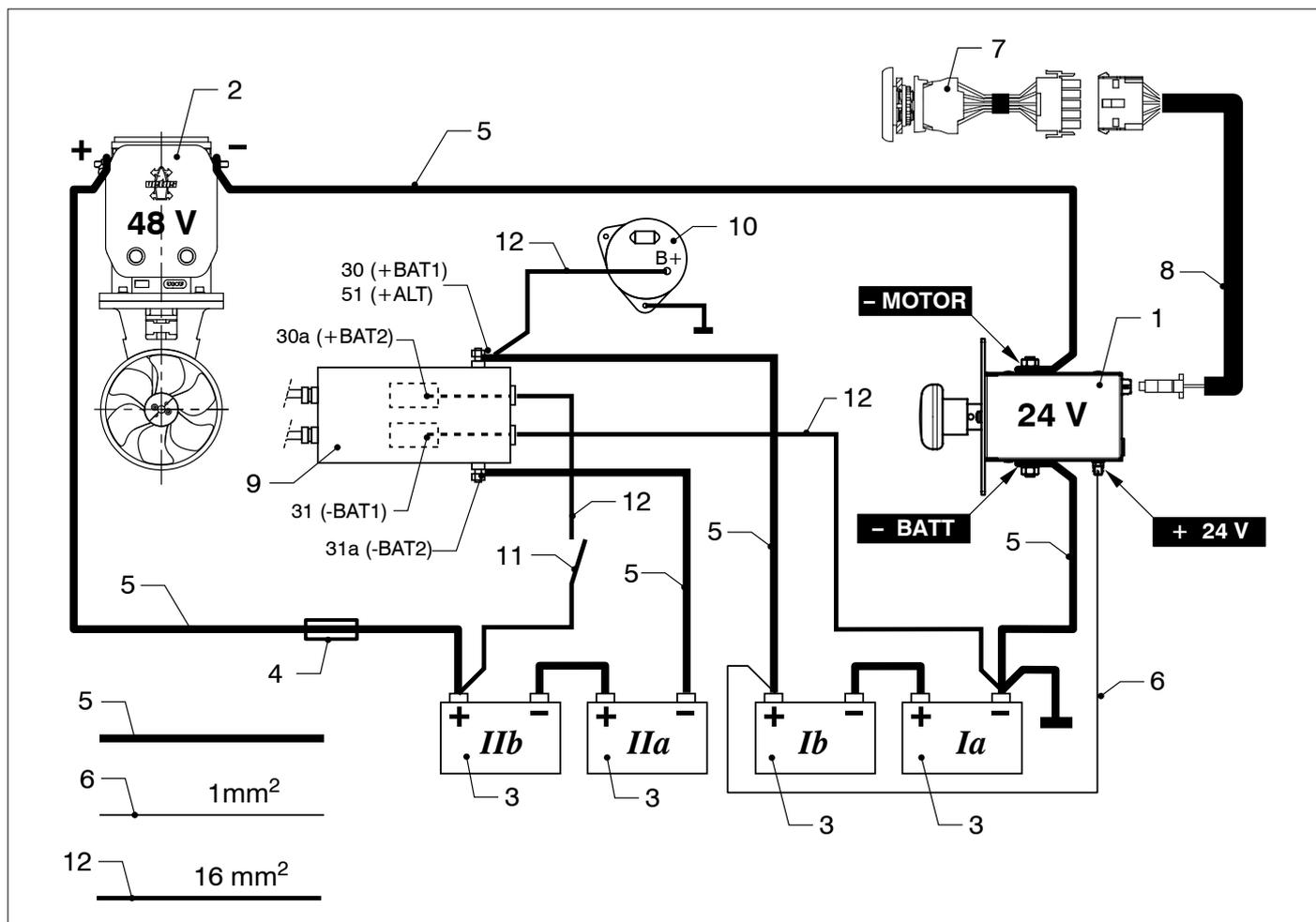
**Installatievoorbeeld met een 48 Volt boegschroef in combinatie met een serie-parallelschakelaar aangesloten op een 24 Volt boordnet**
