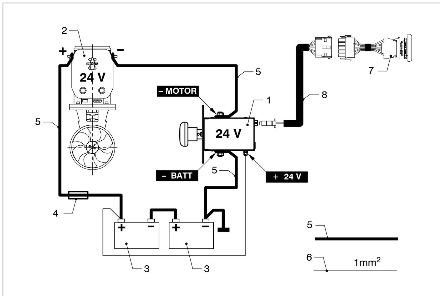
Installatievoorbeeld met een 24 Volt boegschroef
