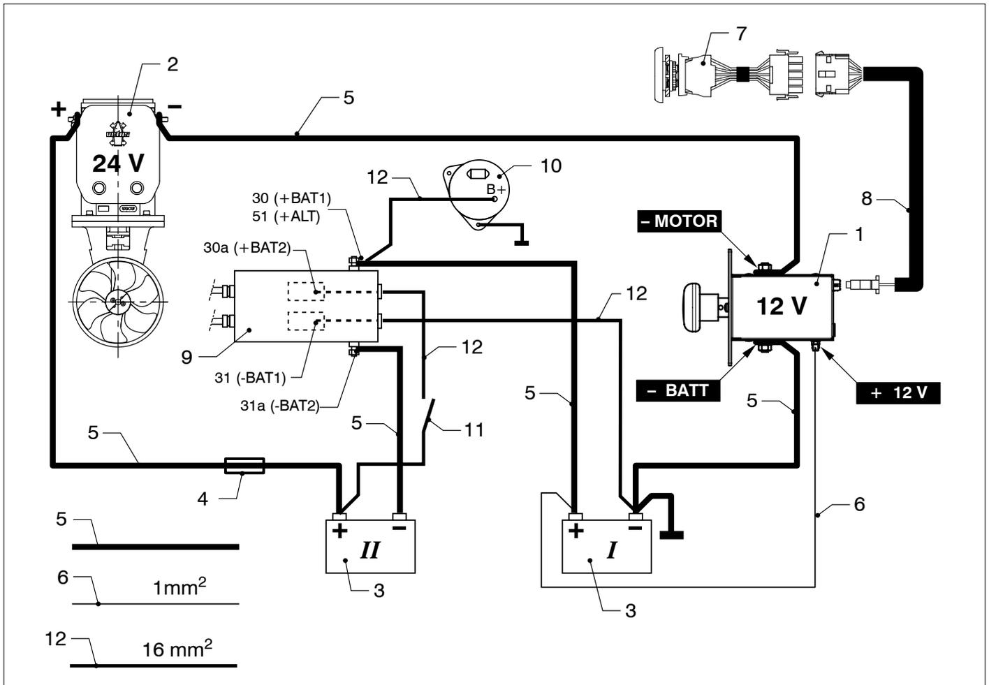
**Installatievoorbeeld met een 24 Volt boegschroef in combinatie met een serie-parallelschakelaar aangesloten op een 12 Volt boordnet**
