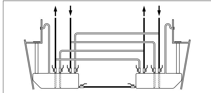
Die Tanks, also das Gewicht, gleichmäßig über das Schiff verteilen.
