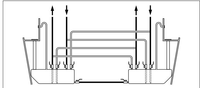
Verdeel de tanks, dus het gewicht, gelijkmatig over het schip.
