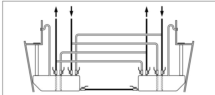
Distribuya los depósitos, el peso, uniformemente en la embarcación. (F = Combustible y W = Agua)..
