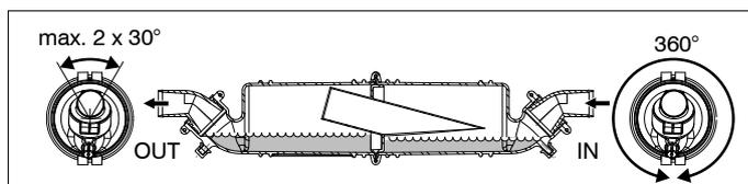
Für ein ordnungsgemäßes Funktionieren ist es erforderlich, dass sich das OUT-Gehäuseteil und die beiden Innenteile in der gezeichneten Position befinden. Eine Verdrehung von maximal 30° nach jeder Seite ist erlaubt. Das IN-Gehäuseteil kann in jeder beliebigen Position angebracht werden.
