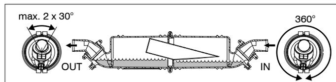
Pour le bon fonctionnement du système, il est essentiel que la partie OUT (sortie) ainsi que les deux pièces intérieure soient dans la position illustrée. Une rotation de 30° maximum de chaque côté est tolérée. La partie IN (entrée) peut être placée dans n'importe quelle position.
