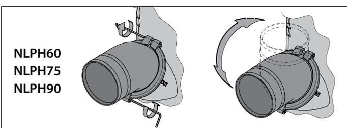
¡Soltar los tornillos antes de girar las conexiones de manguera! Volver a apretar las conexiones de manguera observando un punto de 1 Nm.
