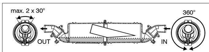
Para un funcionamiento correcto es necesario que la parte de salida (OUT) de la carcasa y las dos partes internas se encuentren en la posición indicada en la imagen. Está permitida una desviación máxima de 30° hacia cada lado. La parte de entrada (IN) de la carcasa puede colocarse en cualquier posición.
