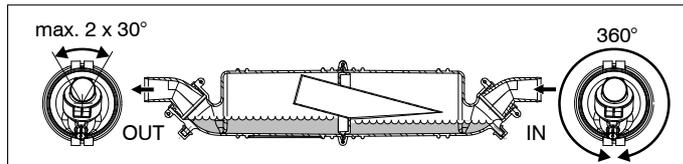
Ai fini di un buon funzionamento è necessario che la parte OUT (USCITA) e le due parti centrali del corpo si trovino nella posizione indicata nel disegno. Una rotazione di 30° in entrambe le direzioni è ammessa. La parte IN può essere montata in qualsiasi posizione.
