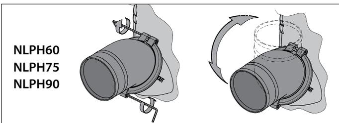
Draai de bouten los alvorens de slang aansluitingen te verdraaien! Schroef de slang aansluitingen weer vast met een aanhaalmoment van 1 Nm.
