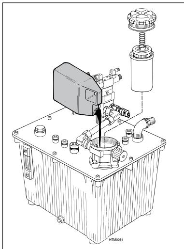
Auf dem Tank befindet sich ein kombiniertes Thermometer/Peilglas.
