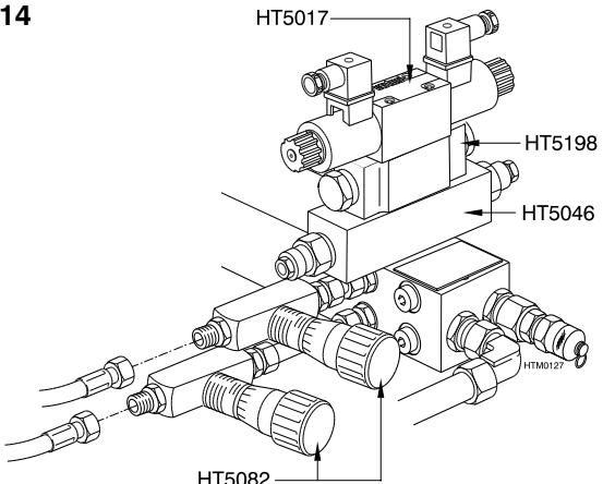
Durante la messa in funzione il flusso deve essere regolato mediante le valvole a farfalla (HT5082). Il flusso dipende dalla velocità dell'impianto ammaina albero.
