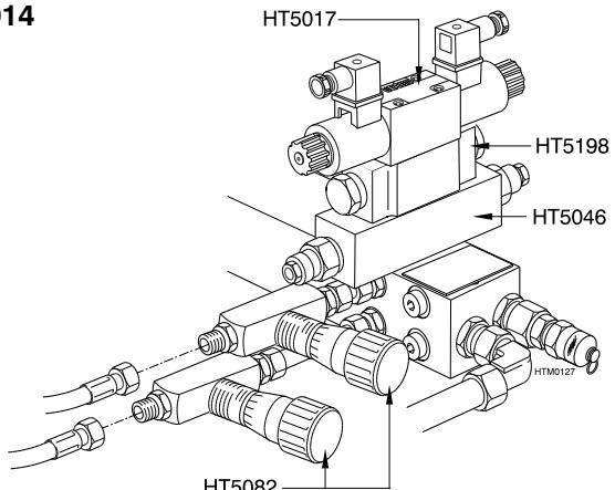
Während der Inbetriebnahme muss der Flow mit den Drosselventilen (HT5082) eingestellt werden. Der Flow steht im Verhältnis zur Geschwindigkeit der Mastabsenkinstallation.
