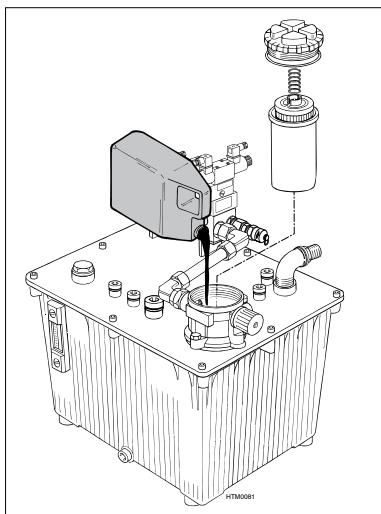
En el depósito se encuentra un termómetro/indicador de nivel combinado. Durante el funcionamiento dos tercios del indicador de nivel han de estar llenos de aceite.
