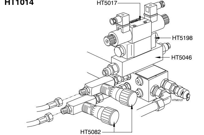
Durante la puesta en marcha, el flujo ha de ajustarse por medio de las válvulas reguladoras (HT5082). El flujo está relacionado con la velocidad del sistema para arriar el mástil.
