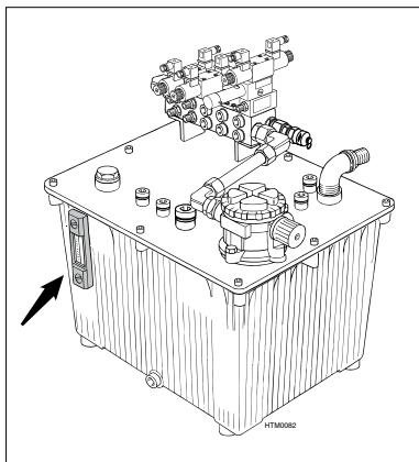
La placa de base quíntuple está provista de un acoplamiento de medición. Encima se puede conectar un manómetro.
