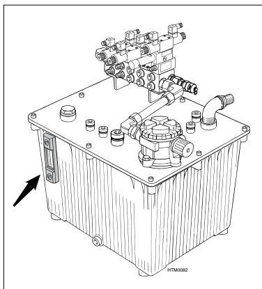
La plaque de base spéciale à 5 valves est dotée d'un raccord de mesure sur lequel un manomètre peut être raccordé.
