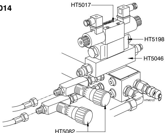
Tijdens inbedrijfstelling moet de flow met de smoorventielen (HT5082) ingesteld worden. De flow is gerelateerd aan de snelheid van de maststrikinstallatie.
