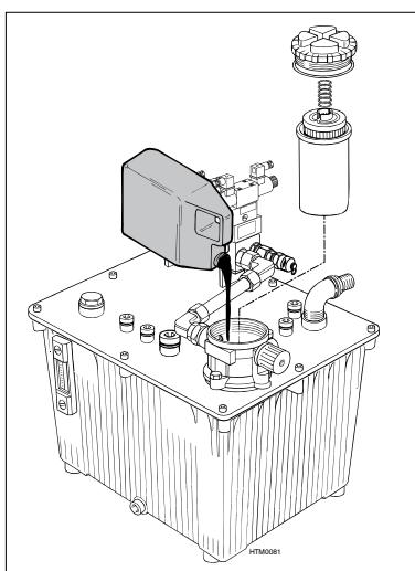
Le réservoir est doté d'un thermomètre/indicateur de niveau combiné.
