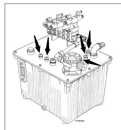
Raccordi per l'impianto di perdita dell'olio che non sono utilizzati:
