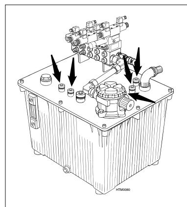
Conexiones de aceite de fuga que no se utilizan:
