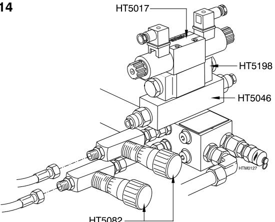
Lors de la mise en service, le débit doit être réglé avec les valves d'étranglement (HT5082). Le débit est lié à la vitesse du dispositif de rabattement du mât. La pression doit être réglée dans la boîte de jonction. **Régler toujours d'abord la basse pression (assemblage 5-7).**
