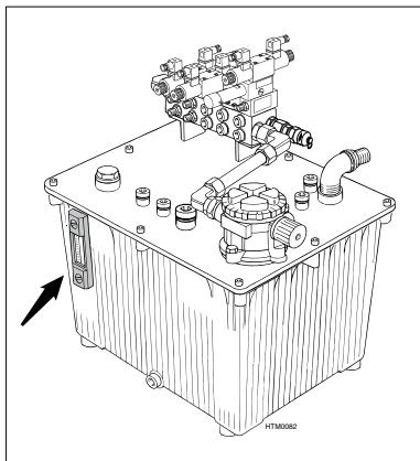
Die 5-Ventil-Basisplatte ist mit einer Messkopplung versehen. Daran kann ein Manometer angeschlossen werden.
