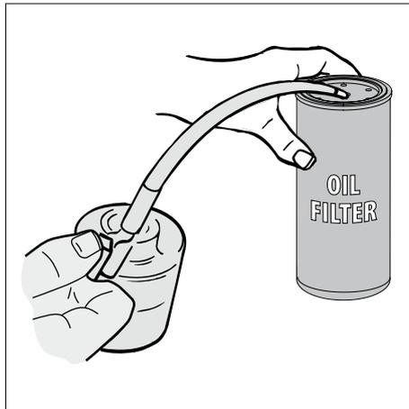
22 Lubrification du joint en caoutchouc
