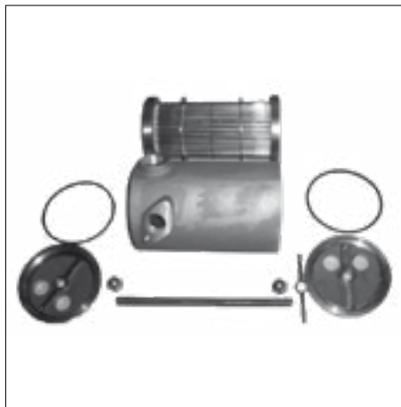
52 Tage varmeveksleren ud
