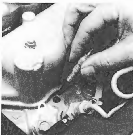
Gloeipluggen verwijderen. Removal of glow plugs.
