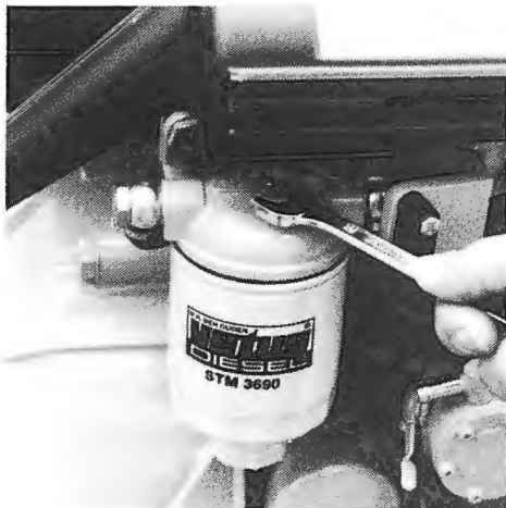
Ontluchtingsnippels openen. Open air bleed nipples.
