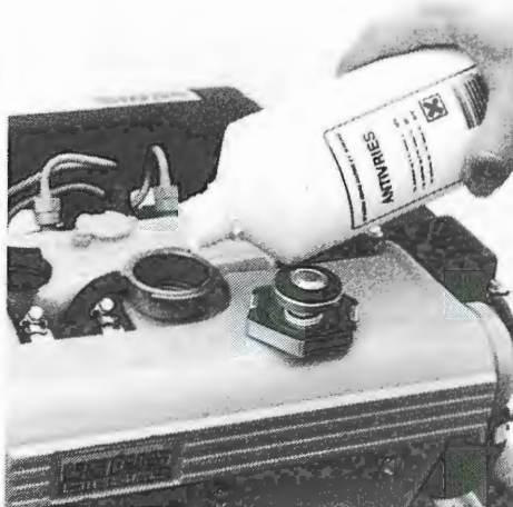
Bijvullen koelsysteem. Topping up coolant.
