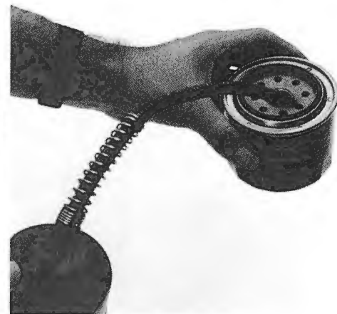
Inoliën rubber ring. Oiling the oil seal.
