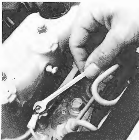
Electrische aansluitingen losnemen. Loosen electrical connections.
