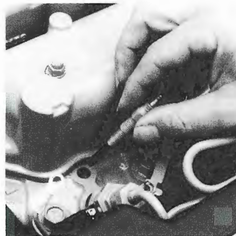
Gloeipluggen verwijderen. Removal of glow plugs.
