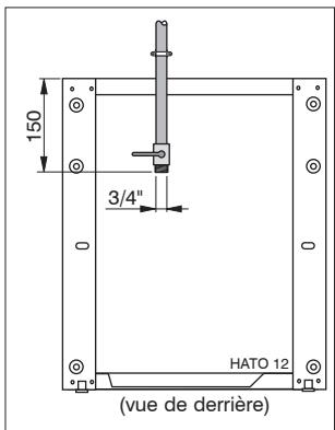
Si un système de pression d'eau a déjà été installé à bord, on peut raccorder le tuyau d'arrivée d'eau à ce système. La pression d'eau de ce système doit cependant atteindre au minimum 1,5 bar, ce qui correspond à la pression minimale nécessaire pour un rinçage optimal des toilettes.
