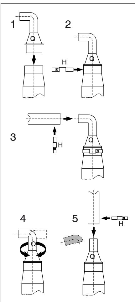
Gebruik als afvoerleiding slang  $\varnothing$  19 mm (bijvoorbeeld 'Vetus geurdichte vuilwaterslang'  $\varnothing$  19 mm).
