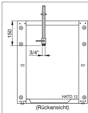
Falls an Bord bereits ein Wasserdrucksystem installiert worden ist, kann der Versorgungsschlauch an dieses System angeschlossen werden. Der Wasserdruck dieses Systems muss allerdings mindestens 1,5 bar betragen; dies ist der für eine optimale Spülung erforderliche Mindestdruck.
