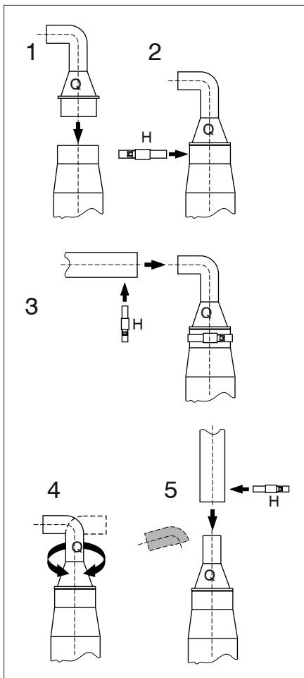
Als Abflussleitung einen  $\varnothing$  19 mm Schlauch benutzen (zum Beispiel den geruchsfreien Vetus-Abwasserschlauch  $\varnothing$  19 mm). Den Abfluss mit den Klemmen befestigen.
