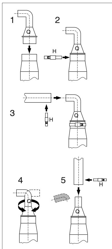
Use como tubería de desagüe una manguera con  $\varnothing$  de 19 mm (por ejemplo, una 'manguera de desagüe antiolores de Vetus con  $\varnothing$  de 19 mm).
