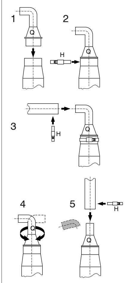
Comme conduite d'évacuation prendre un tuyau de  $\varnothing$  19 mm (par exemple le 'tuyau anti-odeurs pour eaux usées de Vetus'  $\varnothing$  19 mm).
