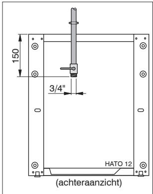
Indien reeds een waterdruksysteem aan boord geïnstalleerd is, kan de toevoerslang op dit systeem worden aangesloten. De waterdruk van dit systeem moet echter wel minimaal 1,5 bar zijn; dit is de minimale druk om een optimale spoeling te verkrijgen.
