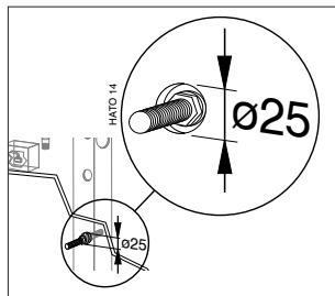
Pourvoir la contre-cloison d'une petite trappe. Le robinet à boule sur le tuyau d'arrivée d'eau reste ainsi accessible sans qu'il soit nécessaire de démonter la cuvette.
