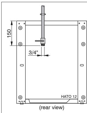
Asegure que la tubería de agua tenga un tapón esférico con una conexión de 3/4" de pulgada para uso externo.
