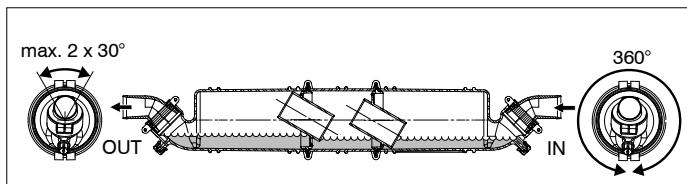
Voor een goede werking is het noodzakelijk dat het OUT (UIT) huisdeel en de beide binnendelen in de getekende stand staan. Een verdraaiing van maximaal 30° naar elke kant is toegestaan. Het IN huisdeel mag in elke stand worden geplaatst.
