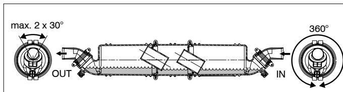
Für ein ordnungsgemäßes Funktionieren ist es erforderlich, dass sich das OUT-Gehäuseteil und die beiden Innenteile in der gezeichneten Position befinden. Eine Verdrehung von maximal 30° nach jeder Seite ist erlaubt. Das IN-Gehäuseteil kann in jeder beliebigen Position angebracht werden.
