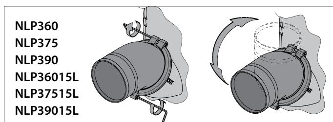
**Desserrer les boulons avant de tourner les raccordements de tuyau!** Revisser les raccordements de tuyau avec un couple de serrage de 1 Nm.
