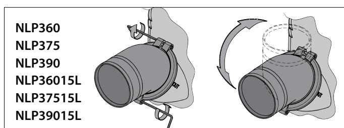
**¡Soltar las tornillos antes de girar las conexiones de manguera!** Volver a apretar las conexiones de manguera observando un punto de 1 Nm.
