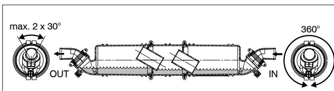
Pour le bon fonctionnement du système, il est essentiel que la partie OUT (sortie) ainsi que les deux pièces intérieure soient dans la position illustrée. Une rotation de 30° maximum de chaque côté est tolérée. La partie IN (entrée) peut être placée dans n'importe quelle position.
