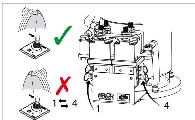
Falls sich beim Probelauf herausstellt, dass die Staurichtung der Bugschraube nicht mit dem Richtungsschalter auf dem Steuerpult übereinstimmt, müssen der blaue (Nr. 1) und der weiße Draht (Nr. 4) auf dem Relais miteinander vertauscht werden.
