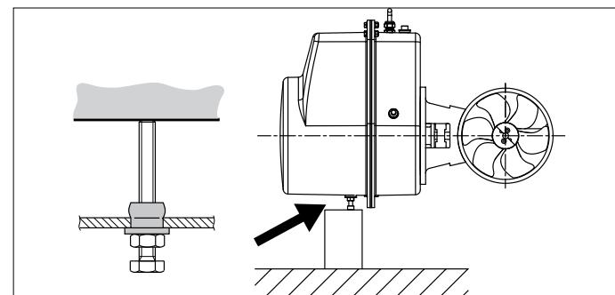
Ist der Motor horizontal aufgestellt, ist eine Stützung absolut notwendig.
