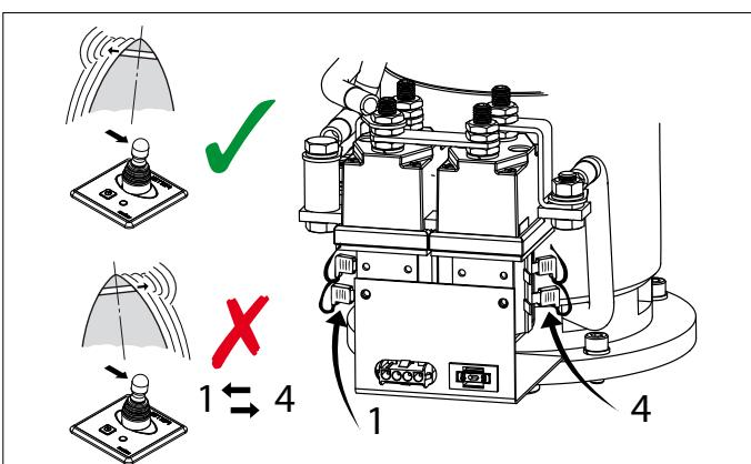
Si la prueba de funcionamiento muestra que la dirección de propulsión de la hélice de proa no es la misma que la indicada por el interruptor de marcha del panel de control, los cables azul (nº 1) y blanco (nº 4) del relé deben intercambiarse.
