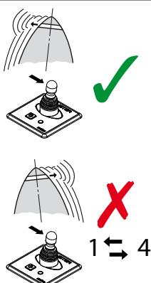
Hvis testen kører viser at stak retning af bow thruster ikke er det samme som der vist retning skifte på kontrolpanelet blå (no.1) og hvid (no.4) skal ledninger på relæet ændres runde.
