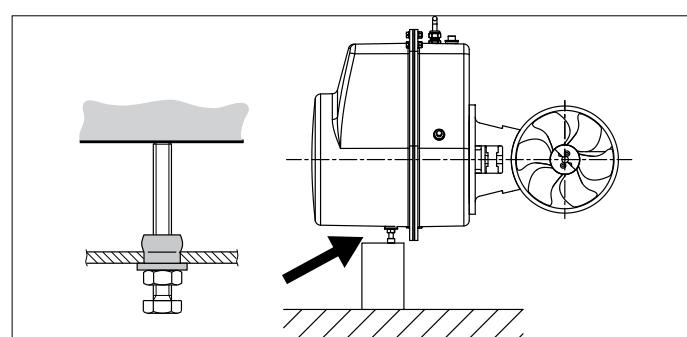
Nel montaggio orizzontale il motore deve essere assolutamente sostenuto.
