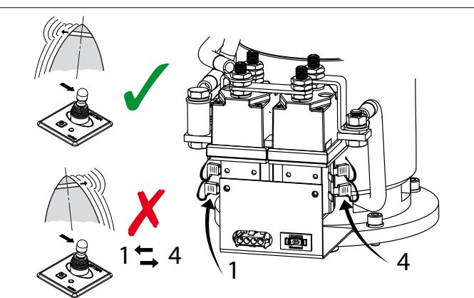
Si l'on constate pendant l'essai que le sens de propulsion de l'hélice d'étrave ne correspond pas à l'interrupteur de direction sur le tableau de commande, il faudra inverser le fil bleu (no.1) et le fil blanc (no.4) sur le relais.
