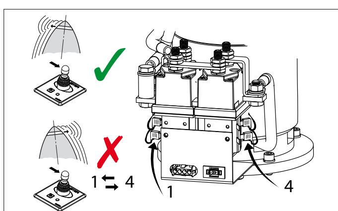
Qualora il senso di rotazione dell'elica di prua non concordi con l'interruttore direzionale sul pannello di comando, è necessario invertire i collegamenti dei fili blu (nr.1) e bianco (nr. 4) sul relè.
