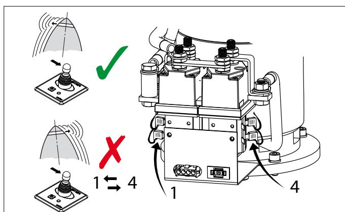
Om testköringen visar att bogpropellerns tryckriktning inte är samma som den som visas i den riktning brytaren på manöverpanelens blåa (nr. 1) och vita (nr. 4) måste kablarna på reläet bytas runt.
