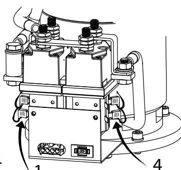
Hvis testoperasjonen viser at baugthrusterens dreieretning ikke er den samme som vist av retningsbryteren på kontrollpanelet, må de blå (n. 1) og de hvite (n. 4) kablene på reléen byttes om.
