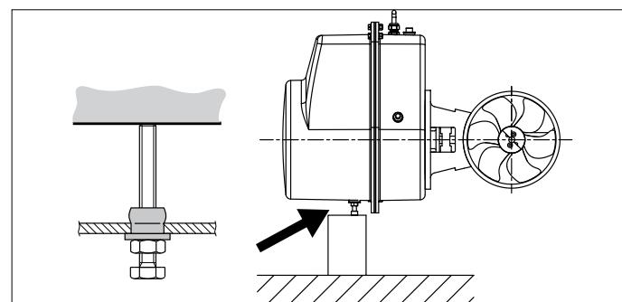
Hvis motoren er placeret vandret er støtte afgørende.
