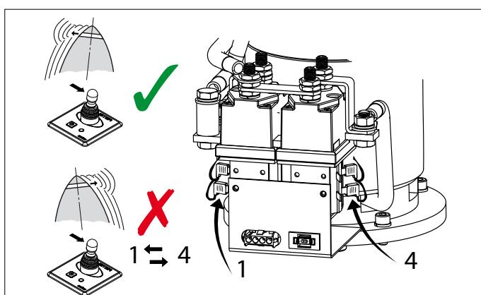
Indien bij het proefdraaien blijkt dat de stuwwrichting van de boegschroef niet overeen komt met de richtingschakelaar op het bedieningspaneel moeten de blauwe (no.1) en de witte (no.4) draad op het relais worden omgewisseld.
