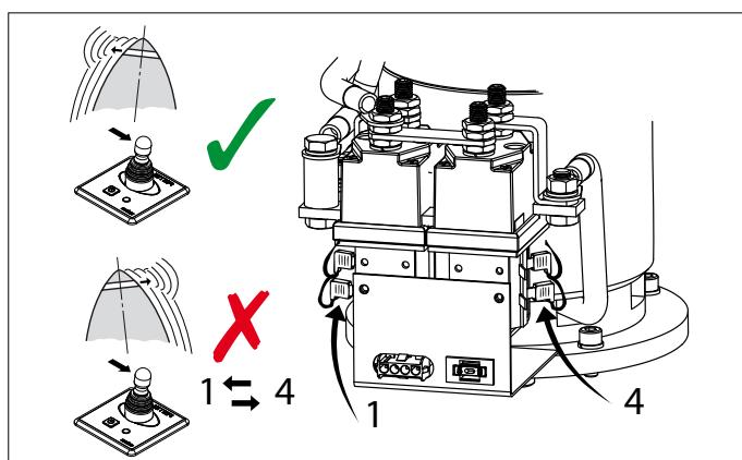
Jeżeli w trakcie przebiegu testu zostanie wykryte, że kierunki ciągu nie odpowiadają kierunkowi przełącznika na pulpicie operatora, wówczas należy w przekaźniku zamienić miejscami przewód niebieski (nr 1) i biały (nr 4).
