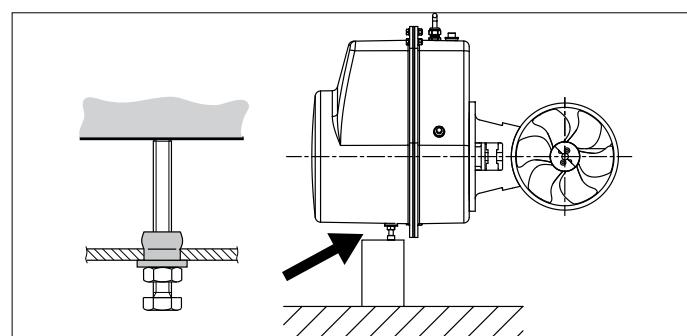
Si le moteur est installé horizontalement, il est absolument indispensable qu'il soit soutenu.
